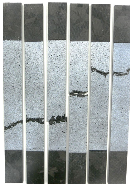
Fig. 6 Failure State (UD Tape Length 26 mm)
