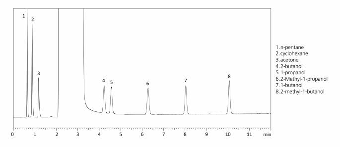
Column : SH-WAX 30 m x 0.53 mm l.D., df= 1.0 μm, P/N : 221-75899-30
