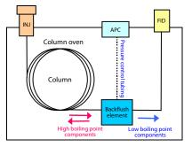
Fig. 1 Backflush GC System
