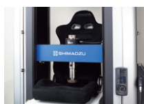
汽车座椅的实物模拟试验
