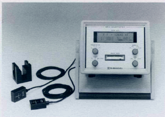
磁界プローブⅡと3軸測定台座（いずれもオプション）の組み合わせ
